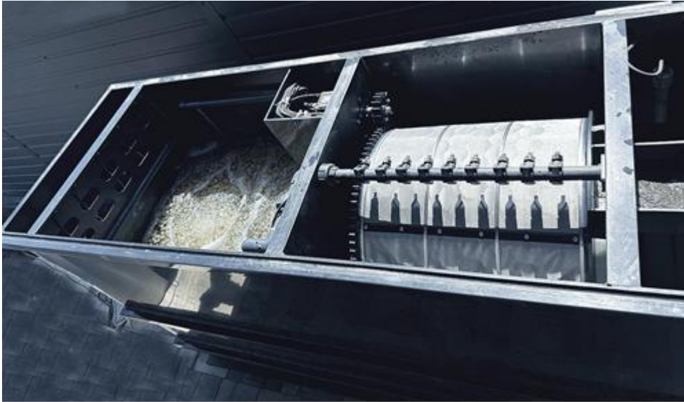
Рис. 3. Удосконалена модульна система очистки води в УЗВ.
