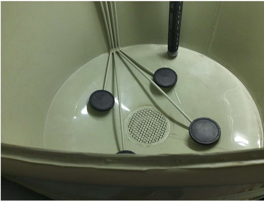
Рис. 2. Конус та подвійне дно для промивки біозавантаження
